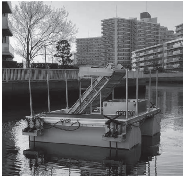
図14 自動航行実験中の6号機 磁気コンパスが狂いがちなエリアでの航行だった
