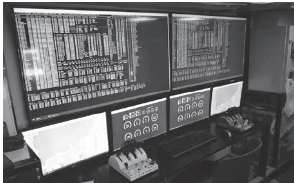
図7 海床ロボットの遠隔モニタリングシステム（2隻同時に実施した）
