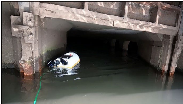
管内に進む Swimmy Eye 下水道点検モデル
