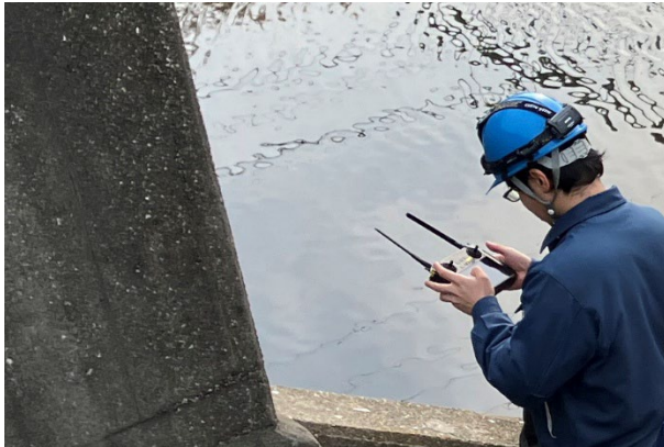
管隣から操作：管口から 14.5m 先まで通信可能
