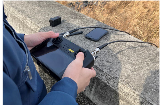
対岸から操作：管口から 24.5m 先まで通信可能
