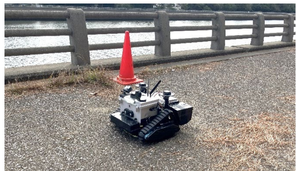
花見川護岸上を陸上走行する水陸両用走行型ドローン
